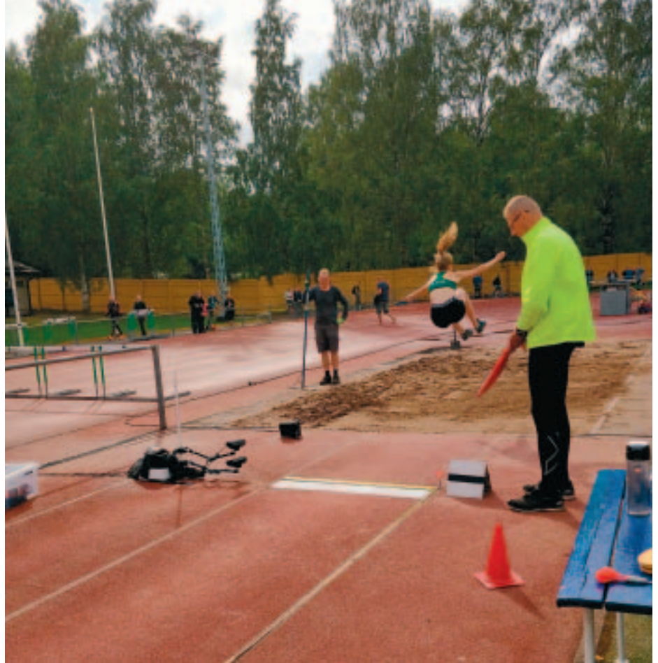
Suomalaista urheiluteknologiaa mittaamassa pituushyppääjän suoritusdataa. Ponnistusetäisyys lankulta mitataan kuvantunnistukseen perustuvilla algoritmeilla ja vauhti hiekan reunalla olevalla lasersäteitä lähettävällä sensorilla.
